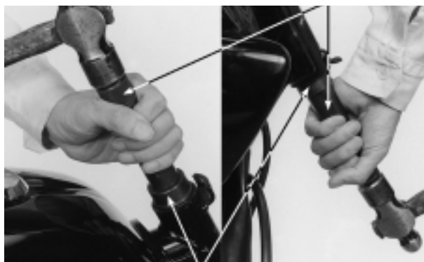
INSTALADOR DE ROLAMENTO 37 x 40 mm
